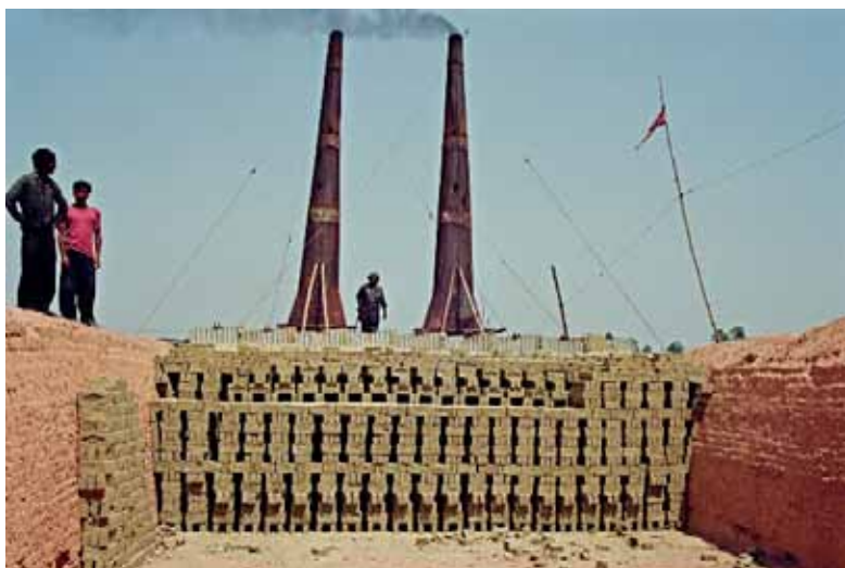
En Bull Trench Kiln med to 15-meter høye bevegelige skorsteiner av tynne metallplater. Disse skorsteinene var svært forurensende og ble forbudt i 2003 og erstattet av høye permanente skorsteiner laget av murstein.
