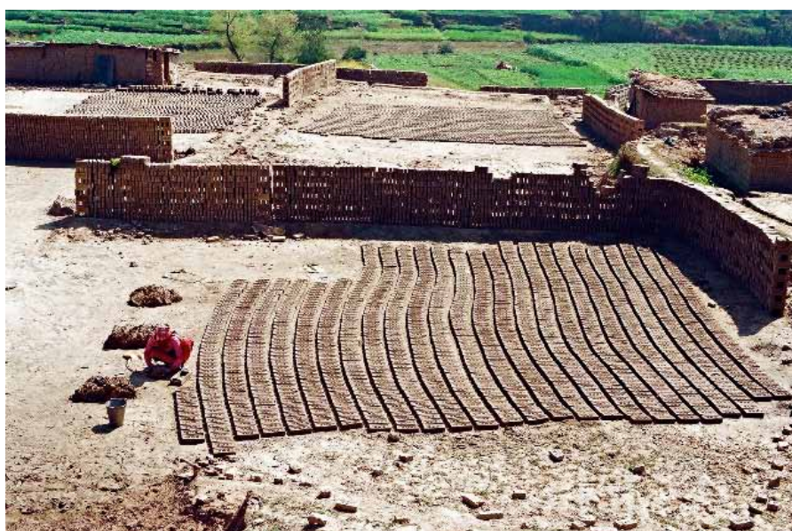
Mursteinene ligger på bakken og tørker til de er faste i formen, så vendes de og ligger til de er helt tørre. Deretter stables de i mannshøye rekker.
